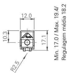
Dimensões do parafuso de fixação
